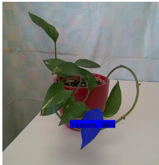
Figura 29. Imatge de la segmentació de les fulles de la planta capturada per la càmera RGB-D mitjançant el seu propi software
