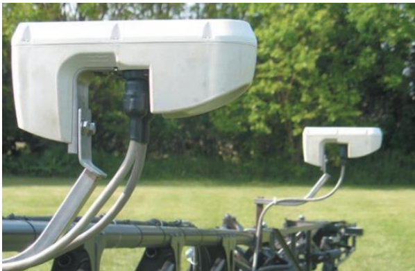
Figura 26. Sensor GreenSeeker ubicat en una pulveritzadora a camp
