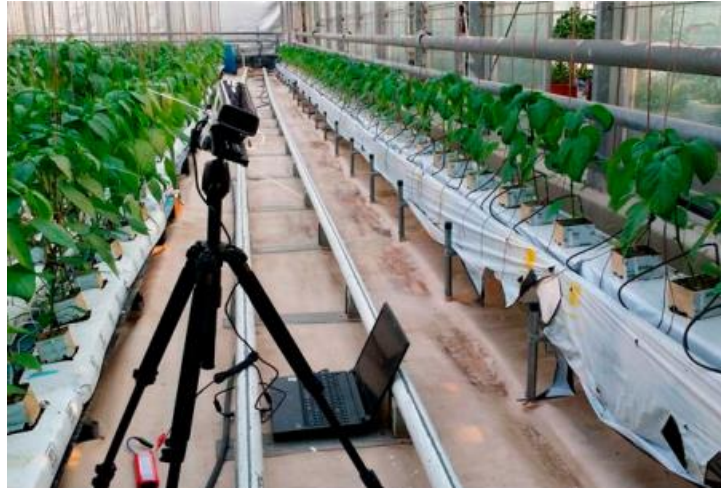
Figura 2. Estructura de la monitorització de plantes mitjançant la càmera Kinect en un hivernacle, Xia et al. (2015)
