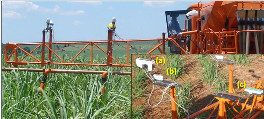
Figura 4. Imatge de a) Sensor GreenSeeker, b) Sensor Crop Circle ACS-210 i c) Sensor Crop Circle ACS-430 muntats en una plataforma d'un vehicle agrícola per l'aplicació de fertilitzants, Amaral et al. (2015)
